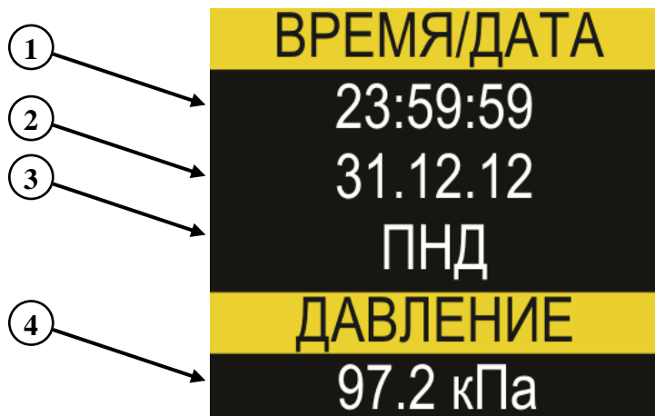
Рисунок 7. Дисплей в режиме "Дата и время"
